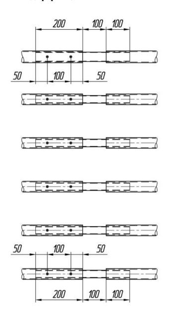
А-8. Устройство концевой (начальной) стойки ограждения. Тип ограждения 1.
