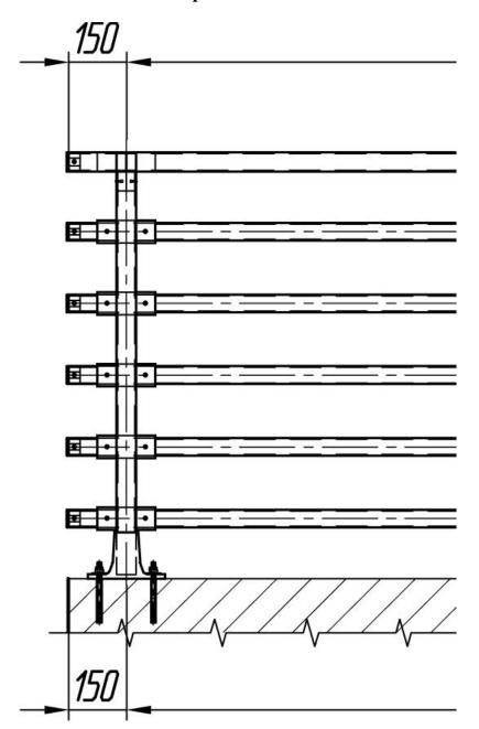
А-9. Устройство концевой (начальной) стойки ограждения. Тип ограждения 2.
